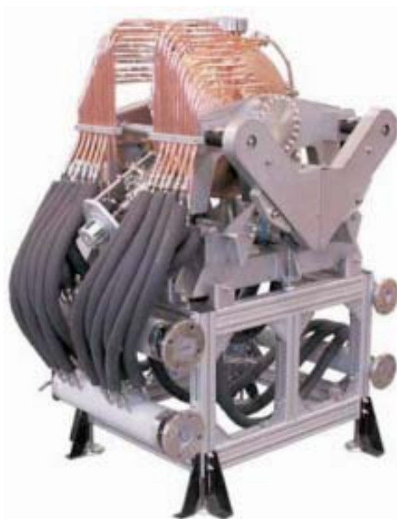
Fig. 4 Cavità risonante a 500MHz prodotta dalla CINEL per il laboratorio ELETTRA di Trieste
