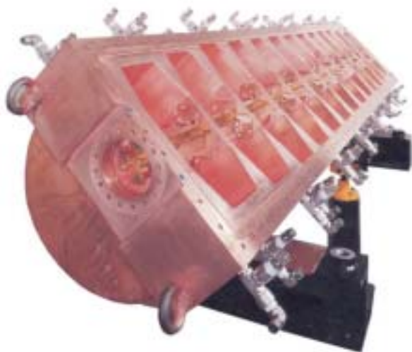
Fig. 2 Monocromatore criogenico a doppio cristallo della CINEL per il laboratorio europeo ESRF di Grenoble
